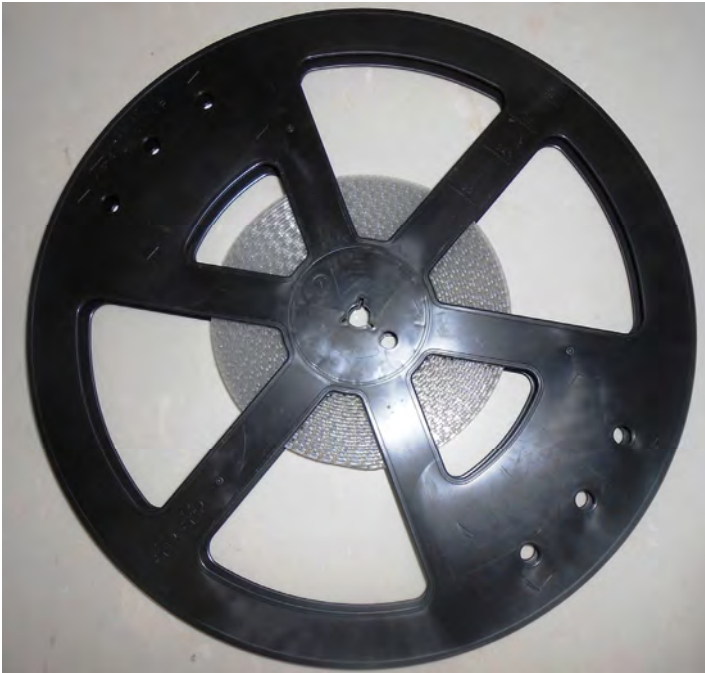
Steckverbinder in einem Rad
